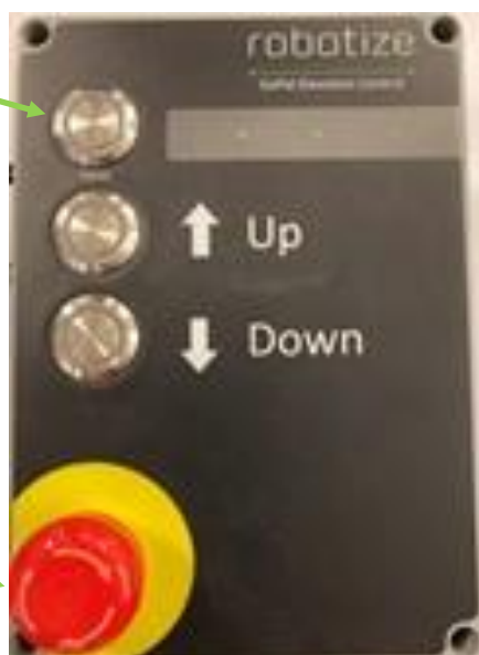
Rys. 32 Panel sterowania stacji paletowej GoPal z windą (EUW)
