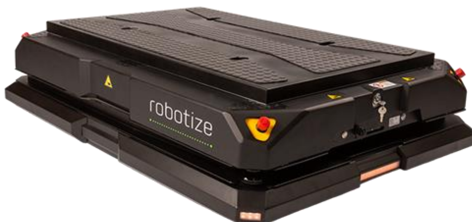
Rys. 5 Robot GoPal od góry (GoPal U24W)
